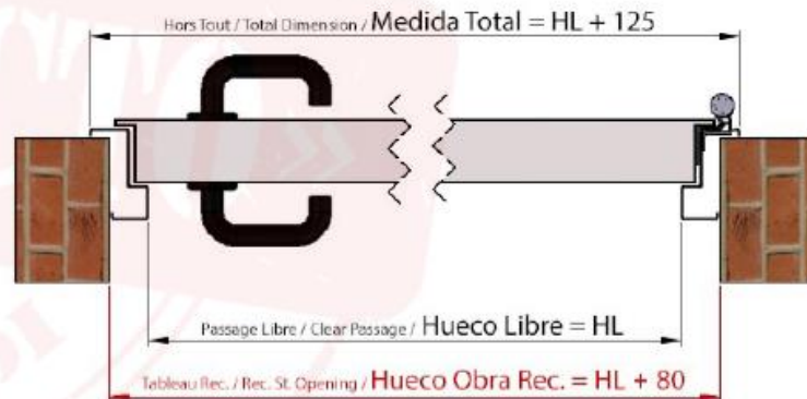
SECCIÓN A-A section A-A section A-A
